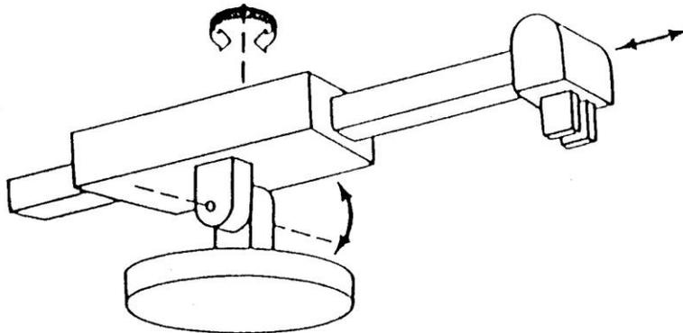
Sferico (un giunto prismatico e due rotoidali)
