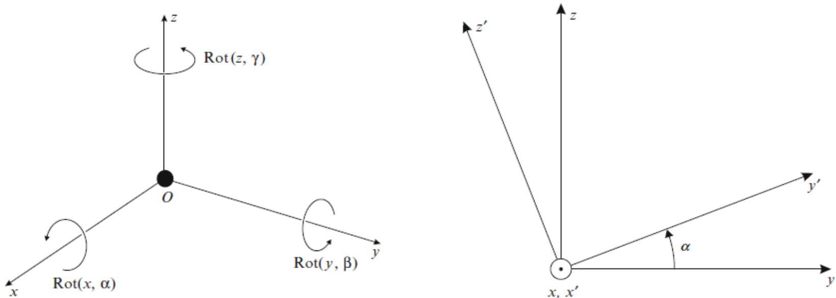
$$\text{Rot}(x, \alpha) = \begin{bmatrix} \cos 0^\circ & \cos 90^\circ & \cos 90^\circ & 0 \\ \cos 90^\circ & \cos \alpha & \cos(90^\circ + \alpha) & 0 \\ \cos 90^\circ & \cos(90^\circ - \alpha) & \cos \alpha & 0 \\ 0 & 0 & 0 & 1 \end{bmatrix} \begin{matrix} x \\ y \\ z \end{matrix} = \begin{bmatrix} 1 & 0 & 0 & 0 \\ 0 & \cos \alpha & -\sin \alpha & 0 \\ 0 & \sin \alpha & \cos \alpha & 0 \\ 0 & 0 & 0 & 1 \end{bmatrix}$$
