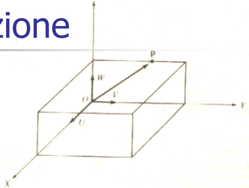
Figura 2.2 Sistemi di coordinate di riferimento e solidali al corpo.
